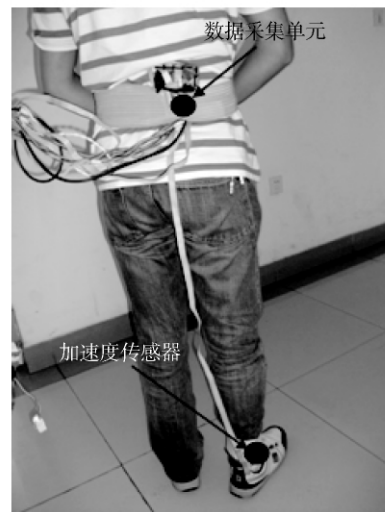
图 1 下肢加速度信号采集实验配置
