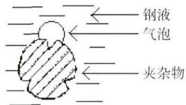
图 5 钢液中气泡异相形核机理示意图
