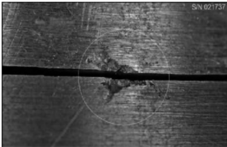
图 1 车轴疲劳裂纹从道砟冲击痕处萌生 [2]
