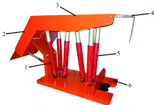
1—后并联支撑机构; 2—后掩护装置; 3—顶梁; 4—伸缩梁; 5—前并联支撑机构; 6—底座
