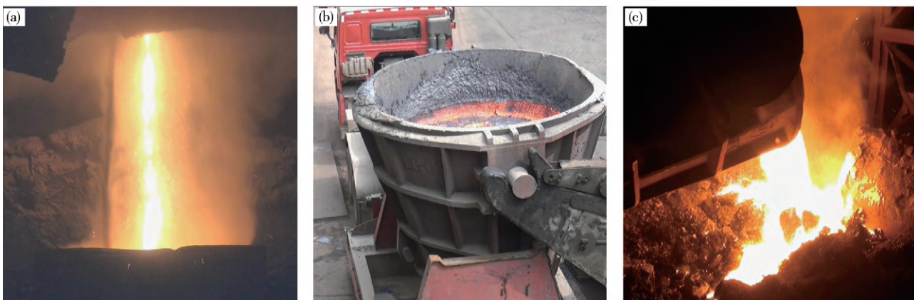
图 6 工业试验过程. (a) 现场熔渣改质过程; (b) 改质渣罐运输过程; (c) 改质渣倾倒过程
