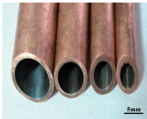
图14 采用浮动芯头拉拔制备的不同规格的铜/钛复合管材
