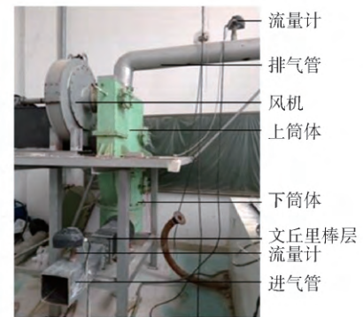
图8 棒式文丘里除尘器实验台
