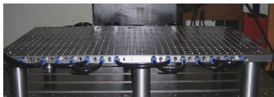
图 3 ArcHLM 工艺采用的带有冷却管的夹具<sup>[7]</sup>
