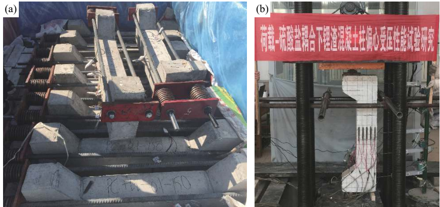
图2 混凝土柱侵蚀及试验图. (a)已施加荷载的钢筋混凝土柱; (b)混凝土柱大偏心受压试验
