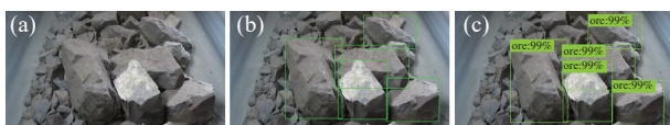
图 10 基于 Faster R-CNN 的皮带大块矿石检测。(a) 原图; (b) 标签; (c) 检测结果
