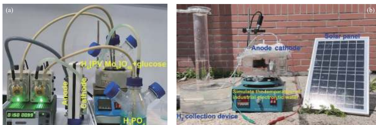
图 13 (a) 葡萄糖氧化辅助 PEM 混合电解水装置示意图; (b) 太阳能电池驱动 PEM 混合电解水装置示意图 [121]
