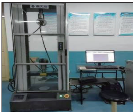
图 4 WDW-50 电液伺服压力机
