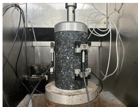
图 3 单轴压缩分级间歇加载试验
