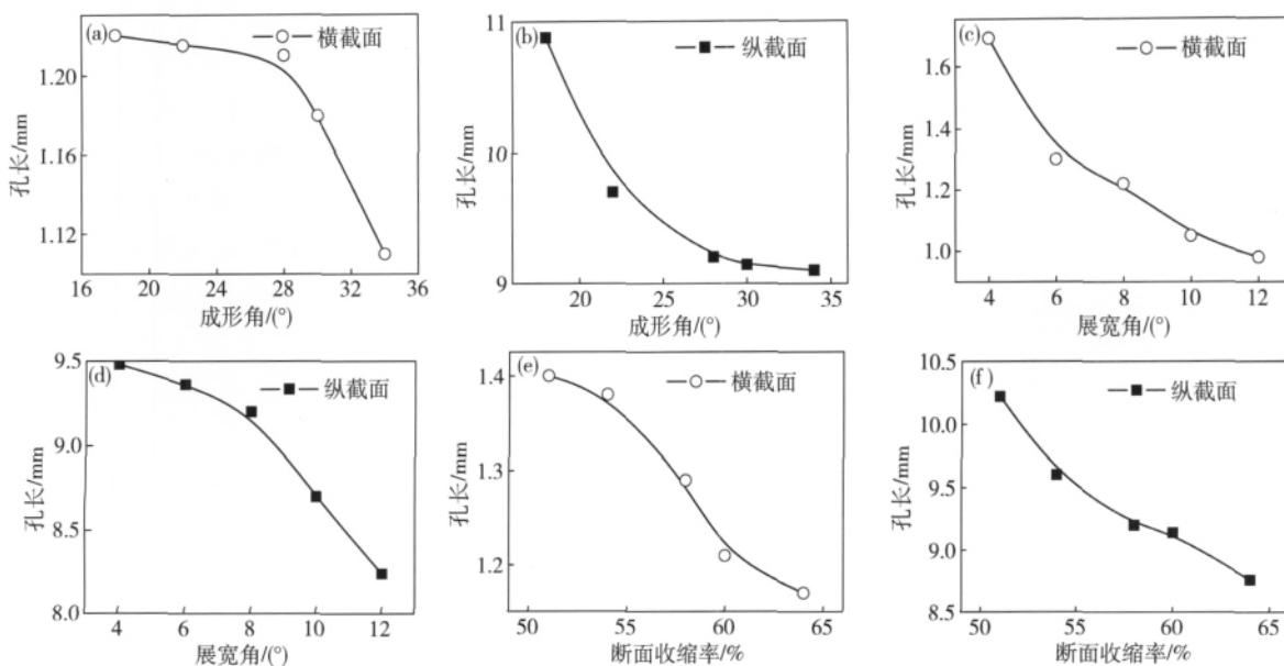
图8 不同工况下的孔长尺寸。(a) 横截面孔长与成形角的关系;(b) 纵截面孔长与成形角的关系;(c) 横截面孔长与展宽角的关系;(d) 纵截面孔长与展宽角的关系;(e) 横截面孔长与断面收缩率的关系;(f) 纵截面孔长与断面收缩率的关系
