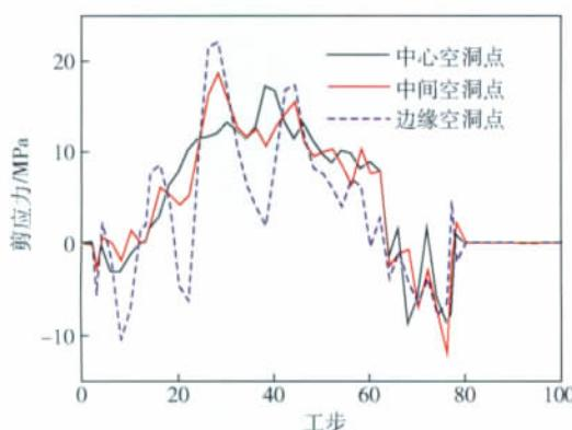
图7 三洞特征点的横向(YZ向)剪应力
