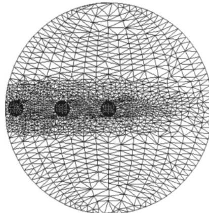
图5 轧件中的多空洞
