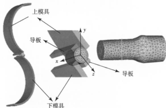
图 1 带洞铝合金轧件楔横轧有限元模型
