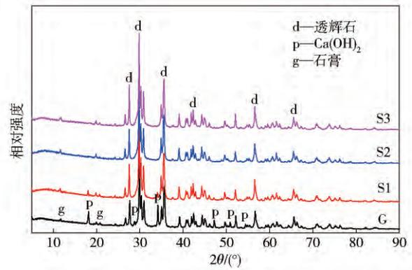
图 3 混合干粉及不同龄期净浆试样 X 射线衍射图谱
