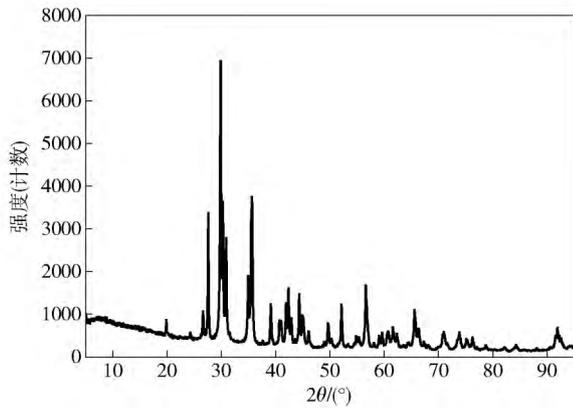
图 1 透辉石的 X 射线衍射图谱
