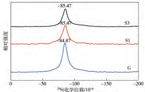
图 7 混合干粉及不同龄期净浆试样  $^{29}\text{Si}$  核磁共振图谱
