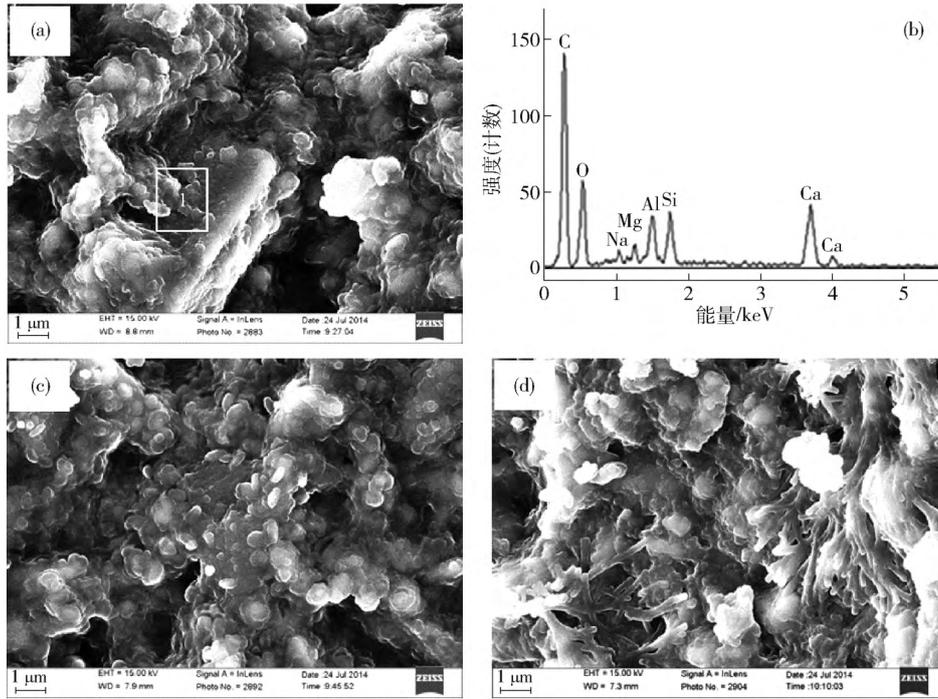
图4 不同龄期透辉石净浆试样的扫描电镜图片。(a) 3 d; (b) 图4(a) 能量色散谱分析; (c) 7 d; (d) 28 d
