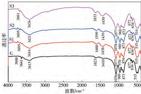
图5 混合干粉及不同龄期净浆试样傅里叶红外光谱
