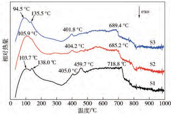
图 6 不同龄期净浆试样差示扫描量热图谱
