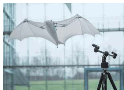
图 5 BinoicFlyingFox 与外部红外相机系统
