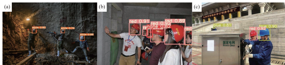
图 6 复杂环境下 DS-YOLOv5 对安全帽佩戴情况检测与识别结果。(a) 光线不足;(b) 遮挡情况;(c) 目标尺度差异
