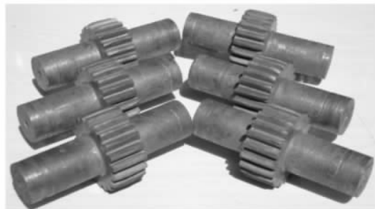
图 14 轧制出的齿坯
