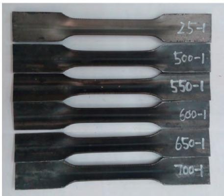
图 5 试验前角部拉伸试样
